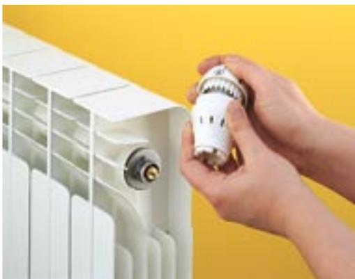
Dopo aver portato la manopola nella posizione desiderata sganciarla tirandola in avanti. Per nessun motivo manomettere la posizione del bulbo, onde evitare perdita di taratura della testa termostatica.
