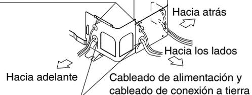
Cuando cablee, use cables monoconductores para el cableado de conexión a tierra, y amarre el cableado de alimentación eléctrica y el cableado de conexión a tierra con abrazaderas como se muestra en la figura de la derecha.
