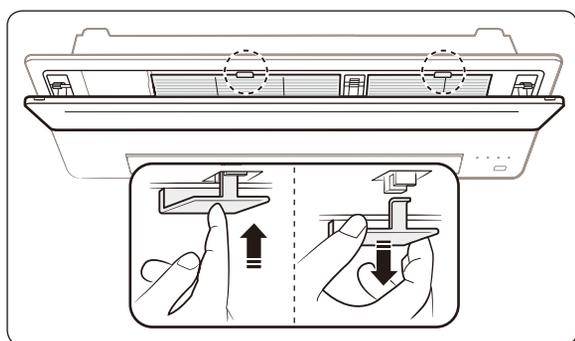
Presione la marca **Push** del filtro de aire. Agarre el asa del filtro de aire y sáquelo de la unidad interior.
