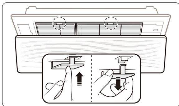
Presione la marca **Push** del filtro de aire. Agarre el asa del filtro de aire y sáquelo de la unidad interior.
