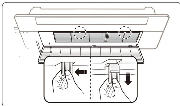
Agarre el asa del filtro de aire y levántelo hacia arriba mientras presiona ligeramente el asa. Saque el filtro de aire de la unidad interior.
