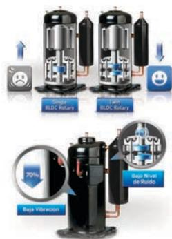
Su Compresor Rotativo Doble se encuentra constituido por piezas de excelente calidad que transmiten estabilidad y durabilidad, fundamental para la eficiencia del FJM. Su rodillo excéntrico doble y dos pesos de balanceamiento brindan como resultado niveles extremadamente bajos de vibración, contribuyendo a una performance mucho más silenciosa.
