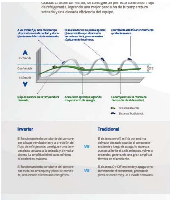
Gracias al sistema inverter, se consigue un perfecto control del flujo de refrigerante, logrando una mejor precisión de la temperatura seteada y una elevada eficiencia del equipo.
