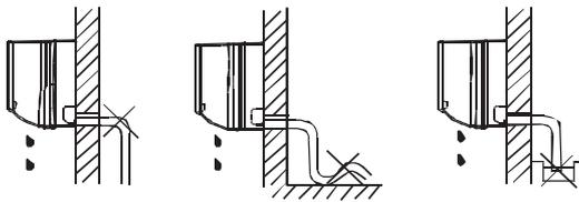
No bloquee el flujo de agua con una elevación.
