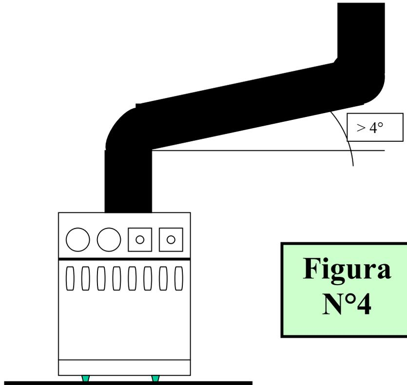
Cuando se deban efectuar cambios de dirección del conducto de ventilación se deberá emplear en lo posible curvas a  $45^\circ$  o menores.
