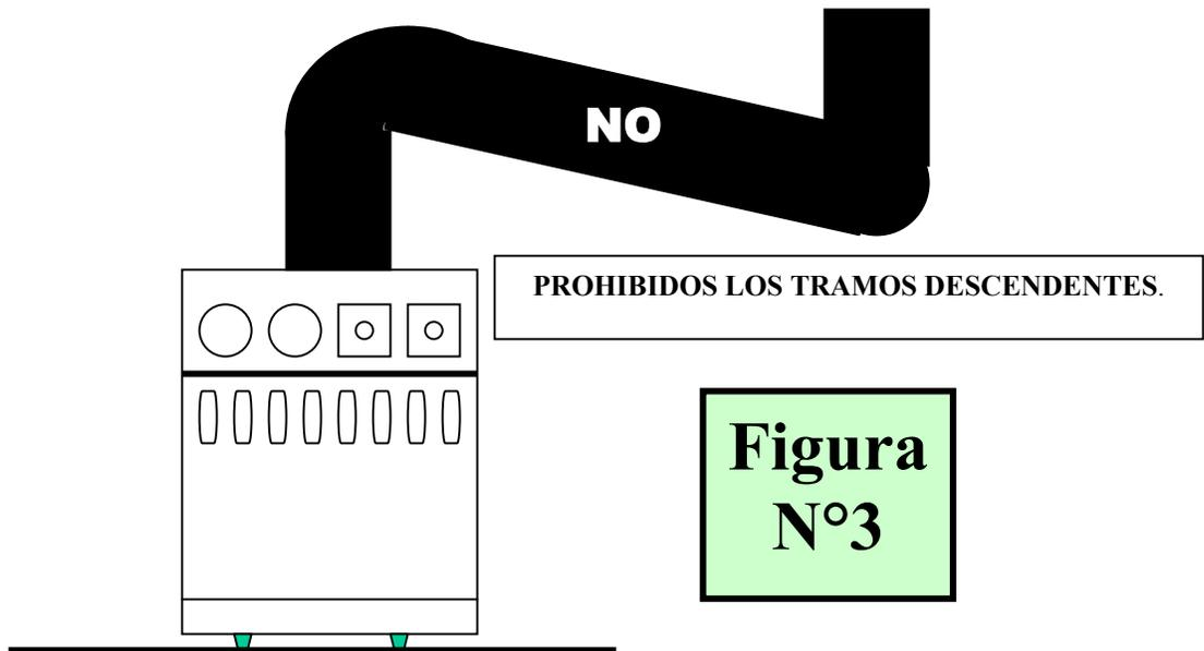
Los tramos ascendentes tendrán una pendiente mínima de  $4^\circ$ , siendo ascendente desde la caldera hacia la salida de gases. (Fig. N° 4).
