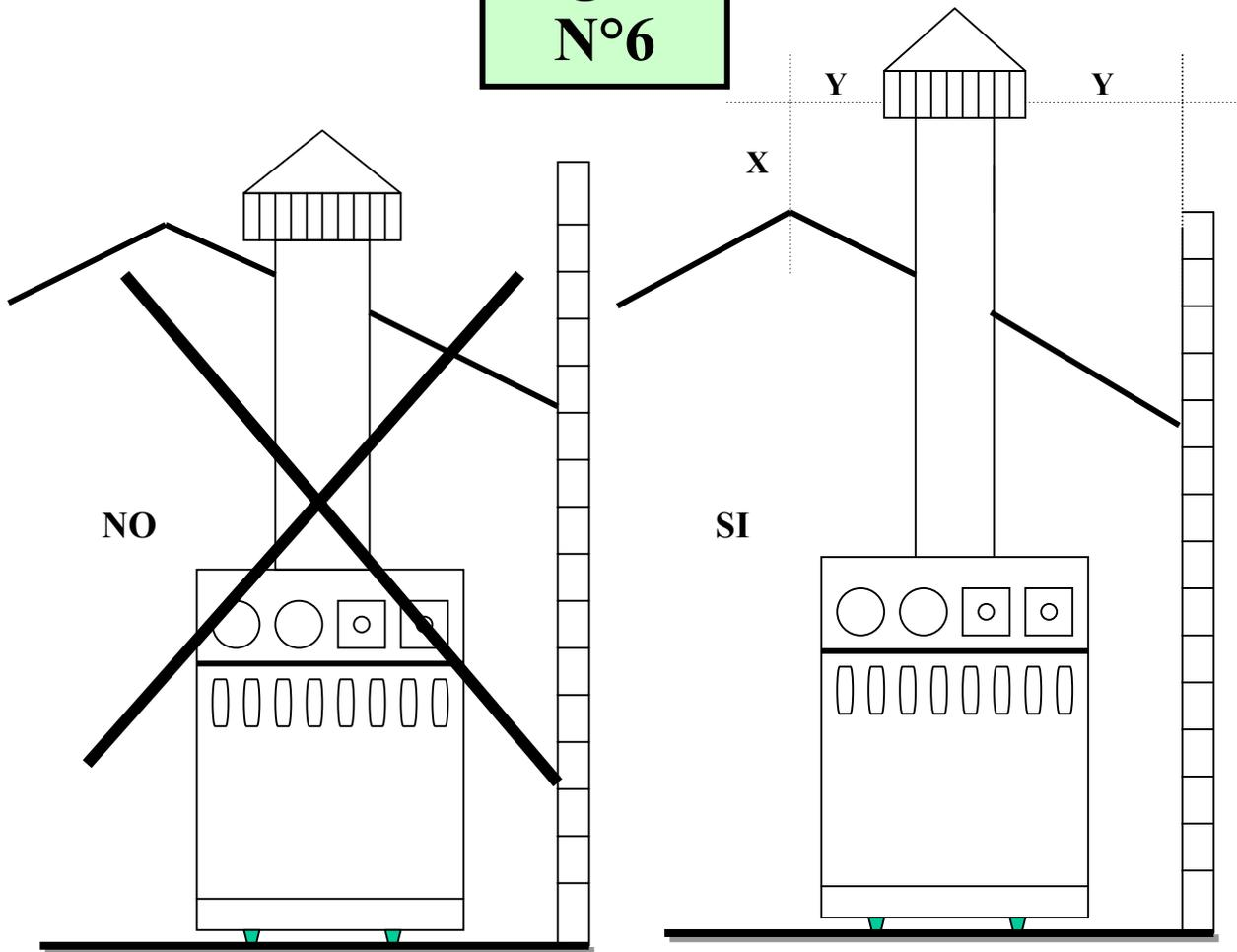
Si esta caldera se destina a **REEMPLAZAR** a otra existente, verifique previamente su compatibilidad con el sistema de ventilación existente.
