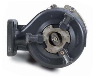
Un sistema de corte muy eficiente (pendiente de patente) garantiza que todos los sólidos de las aguas fecales sean triturados para que puedan ser eliminados mediante el bombeo a través de tuberías con diámetros de mínimo 40 mm.
