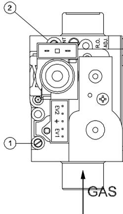
**ATENCION:** Para la verificación de la presión de entrada de gas es necesario que funcione el quemador de la caldera.
