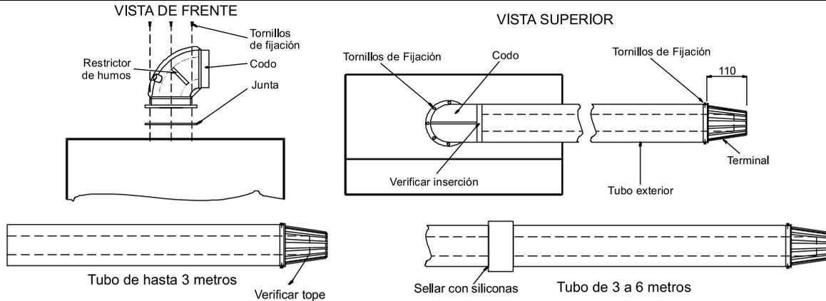
**ATENCIÓN:** En el caso de utilizar una salida de humos de más de 1m de longitud, se deberá desmontar el restrictor de humos del codo de salida de la caldera. En todos los casos el tubo interior de aluminio debe ser un tramo único sin uniones.
