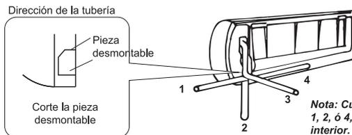
**Nota:** Cuando instale la tubería en las direcciones 1, 2, ó 4, corte la pieza desmontable de la unidad interior.
