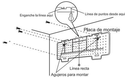
**Nota:** La forma de su placa de montaje puede ser diferente a la que aparece en este gráfico pero el método de instalación es similar.
