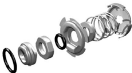
Fig. 13 Despiece del cierre
