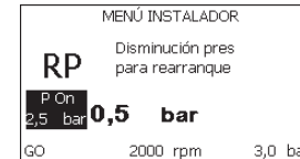
Figura 17: Configuración de la presión de reencendido
